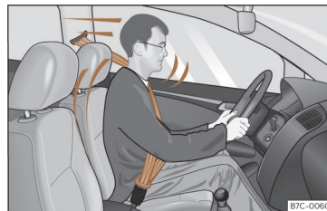
Fig. 16 Hvis sikkerhedssele er spændt korrekt, bliver føreren ikke kastet frem ved en pludselig opbremsning.
