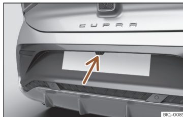
Fig. 100 I stødfangeren bagest: placering af kamera til bakassistent
