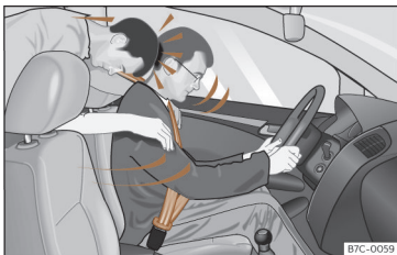
Fig. 18 En bagsædepassager, der ikke har sikkerhedssele på, bliver kastet fremad og ind i den fastspændte fører.
