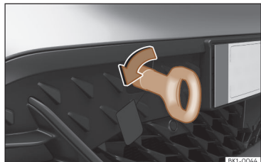
Fig. 150 Stødfanger foran i højre side: slæbeøjje, der er skruet i
