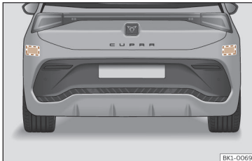
Fig. 98 Bilens set bagfra: radarsensornes områder
