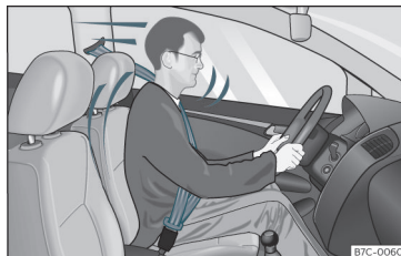
Fig. 6 Hvis sikkerhedsselen er spændt korrekt, bliver føreren ikke kastet frem ved en pludselig opbremsning.
