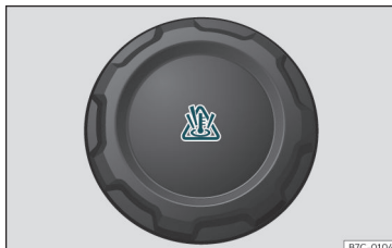
Fig. 207 Motorrum: dæksel på motorkølevæskeekspansionsbeholder
