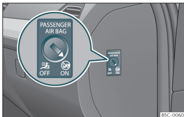
Fig. 15 Nøglekontakt til til- og frakobling af forsædepassagerens frontairbag
