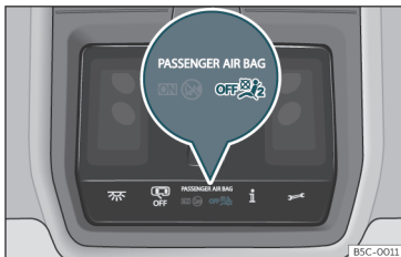
Fig. 16 I tagkonsollen: kontrollampe, der viser, om forsædepassagerens airbag er frakoblet
