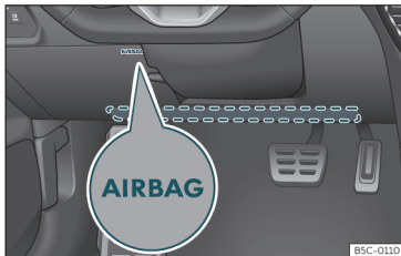
Fig. 17 I førersiden: knæairbaggens monteringssted
