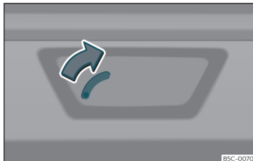
Fig. 85 Udsnit af bagagerummet: nødoplåsning
