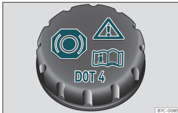
Fig. 208 I motorrummet: dæksel på bremsevæskebeholder
