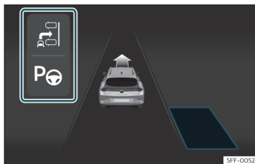
Fig. 175 På kombiinstrumentets skærm: visning af parkeringsstyreassistenten med begrænset visning.
