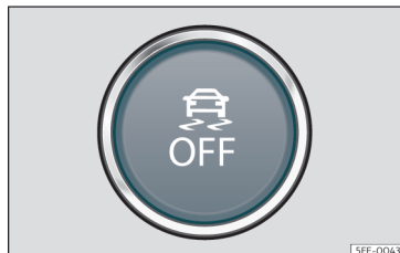
Fig. 174 I den nederste del af midterkonsollen: knap til aktivering/deaktivering af ESC
