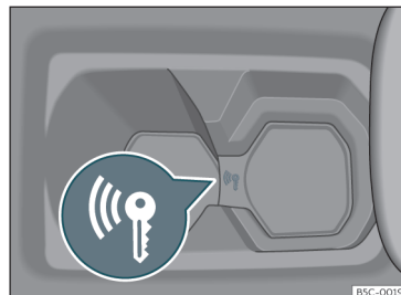
Fig. 139 I midterkonsollen: nødstart
