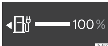
Fig. 58 Frit konfigurerbart kombiinstrument: visning af batteriladetilstand
