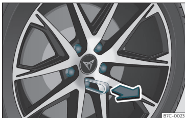
Fig. 35 Hjul: hjulbolte med dækkapper
