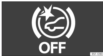
Fig. 155 På kombiinstrumentets skærm: visning af deaktiveret Front Assist
