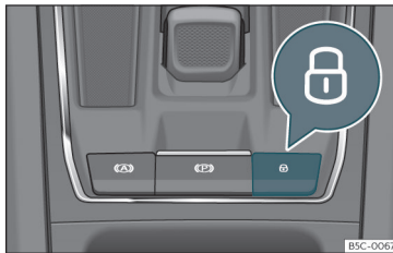
Fig. 75 I midterkonsollen: centrallåskontakt
