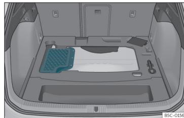
Fig. 211 Batteriets placering i bagagerummet
