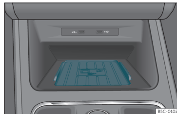
Fig. 135 I midterkonsollen: holder til parring af mobiltelefon
