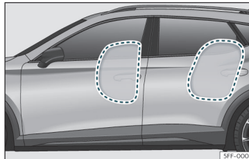
Fig. 22 Fuldt oppustede sideairbags i venstre side af bilen
