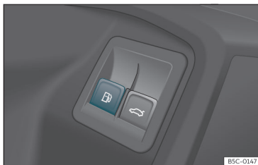
Fig. 196 Førerø: åbning af tankklap
