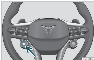
Fig. 144 Multifunktionsrat*: knap til køreprofil-skift
