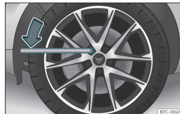
Fig. 37 Hjulskift: løsning af hjulbolte
