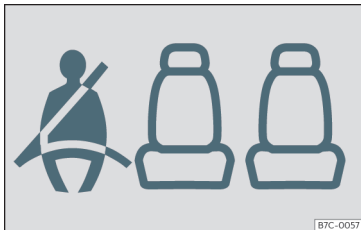
Fig. 5 Cockpit: indikator for, at venstre bagsædeplads er optaget, og at passageren har spændt sin sikkerhedssele
