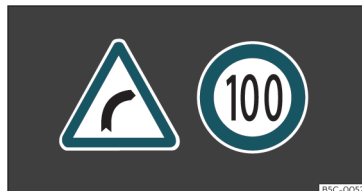
Fig. 54 På kombiinstrumentets skærm: eksempel på registrerede vejskilte
