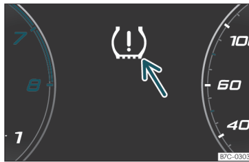
Fig. 215 Cockpit: advarsel om dæktrykstab
