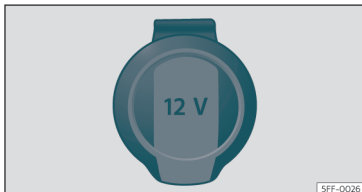
Fig. 125 12-volts-stikdåse: i i armlænet foran
