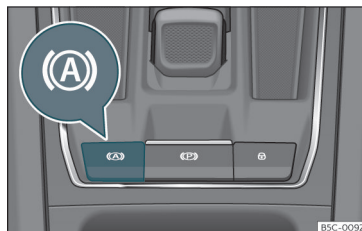
Fig. 173 I den nederste del af midterkonsollen: knap til Auto Hold-funktion
