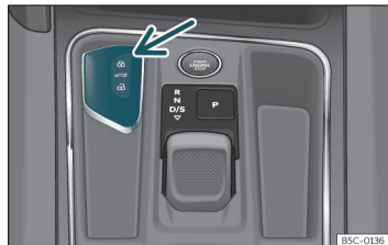
Fig. 70 Midterkonsol: holder til bilnøgler
