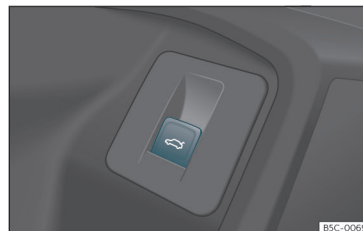
Fig. 83 I førerdøren: kontakt til åbning og lukning af bagklap
