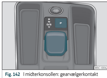
Fig. 142 I midterkonsollen: gearvælgerkontakt
