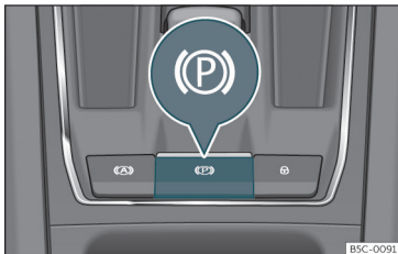
Fig. 172 I den nederste del af midterkonsollen: kontakt til elektronisk parkeringsbremse
