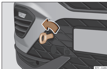
Fig. 42 I højre side af den forreste stødfanger: slæbeøje, der er skruet i
