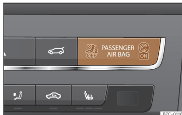
Fig. 16 Instrumentpanel: kontrollampe, der viser, om forsædepassagerens airbag er frakoblet
