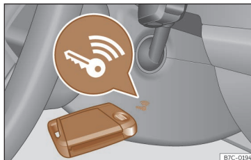
Fig. 135 På højre side af ratstamme: nødstart
