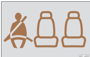
Fig. 5 Kombiinstrument: indikator for, at venstre bagsædeplads er optaget, og at passageren har spændt sin sikkerhedssele
