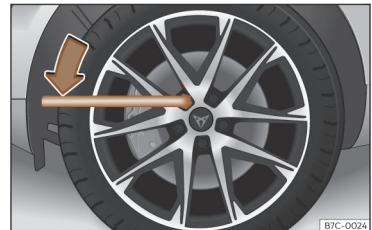
Fig. 34 Hjulskift: løsning af hjulbolte
