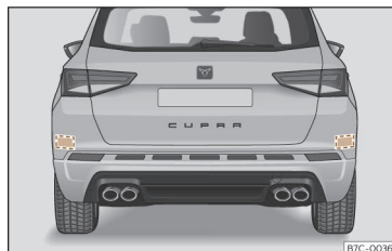
Fig. 146 Bilen set bagfra: radarsensorenes områder
