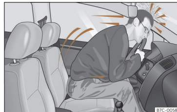
Fig. 7 En fører, der ikke har sikkerhedssele på, bliver kastet fremad.
