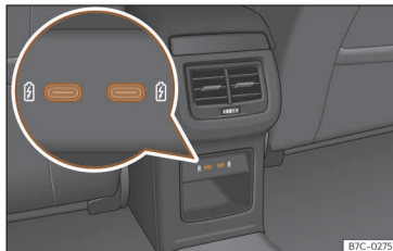
Fig. 133 Midterkonsol bag: USB-porte med stikdåsefunktion
