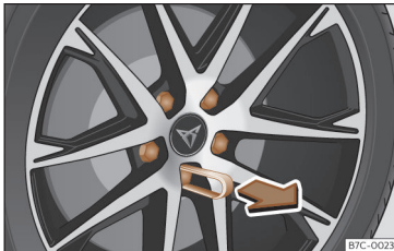
Fig. 32 Hjul: hjulbolte med dækkapper
