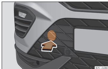
Fig. 41 I højre side af den forreste stødfanger: fjernelse af afdækning
