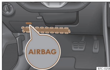
Fig. 17 I førersiden: knæairbaggens monteringssted
