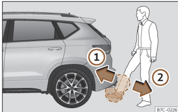
Fig. 80 Bagklap med sensorstyret åbning (Easy Open)
