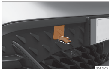
Billede 183 I højre side af den forreste stødfanger: fjernelse af afdækning
