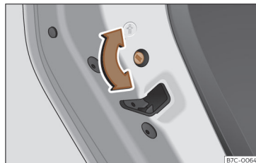
Billede 88 Børnesikring i venstre dør
