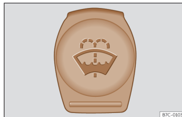
Billede 194 I frontrummet: blåt dæksel på sprinklervæskebeholderen
