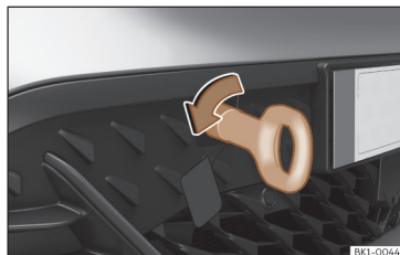
Fig. 42 I den forreste stødfanger i højre side: iskruning af slæbeøjje
