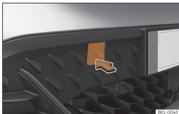
Fig. 41 I den forreste stødfanger i højre side: fjernelse af afdækning
