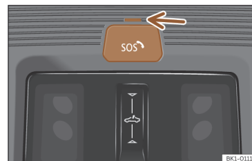
Fig. 33 I tagkonsollen: knap til nødopkaldsfunktionen eCall (bag afdækningen til knappen) og kontrollampe (pil)
