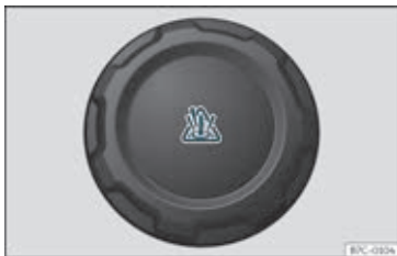
Fig. 218 Motorrum: dæksel på motorkølevæskeekspansionsbeholder
