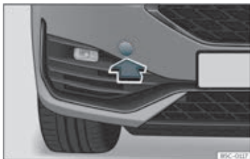
Fig. 47 I højre side af den forreste stødfanger: fjernelse af afdækning
