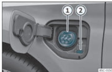
Fig. 202 Bag batteriladeklappen forrest i venstre side: ladestikdåse
