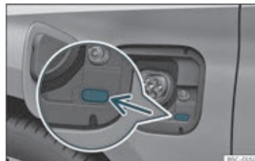
Fig. 203 Bag batteriladeklappen: opladningsindikator
