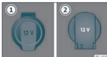
Fig. 140 12-volts-stikdåse: ① i armlænet foran, ② i bagagerummet
