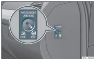
Fig. 19 Nøglekontakt til til- og frakobling af forsædepassagerens frontairbag
