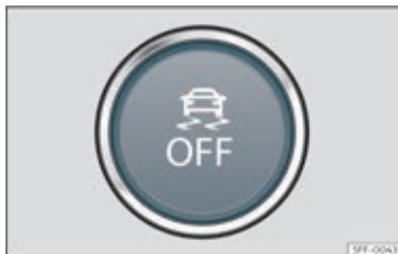
Fig. 188 I den nederste del af midterkonsollen: knap til aktivering/deaktivering af ESC
