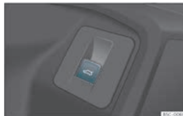
Fig. 87 I førerdøren: kontakt til åbning og lukning af bagklap
