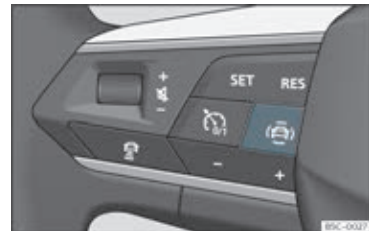
Fig. 66 Venstre side af multifunktionsrattet: knap til førerassistentsystemer (afhængigt af model)
