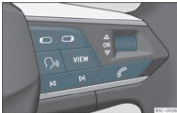
Fig. 64 Højre side af multifunktionsrattet: betjeningsselementer til menuer og informationer i kombiinstrumentet (afhængigt af udstyr)
