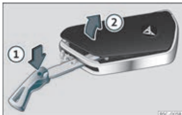
Fig. 76 Bilnøgle: åbning af afdækning til batterirum
