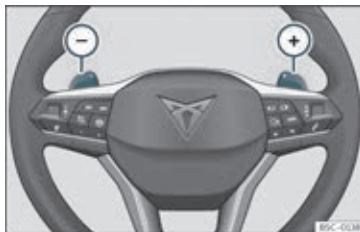
Fig. 157 Rat: gearvælger til automatisk gearkasse
