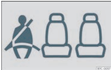
Fig. 9 Kombiinstrument: indikator for, at venstre bagsædeplads er optaget, og at passageren har spændt sin sikkerhedssele
