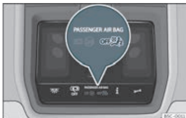
Fig. 20 I tagkonsollen: kontrollampe, der viser, om forsædepassagerens airbag er frakoblet
