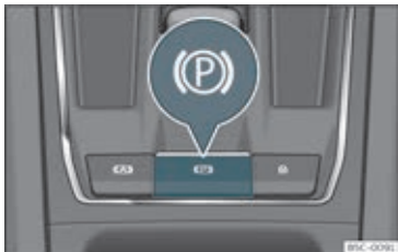
Fig. 186 I den nederste del af midterkonsollen: kontakt til elektronisk parkeringsbremse
