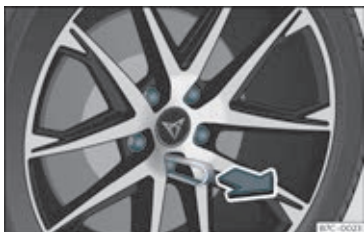
Fig. 39 Hjul: hjulbolte med dækkapper
