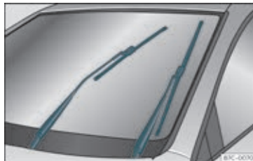
Fig. 44 Viskere i serviceposition
