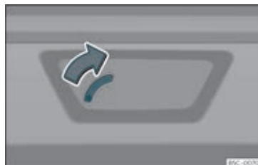
Fig. 90 Udsnit af bagagerummet: nødoplåsning (Leon Sportstourer)
