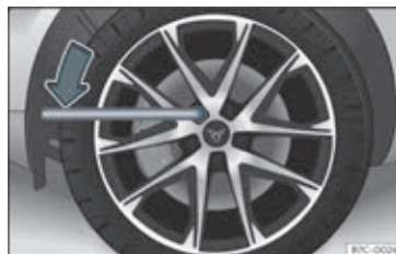
Fig. 41 Hjulskift: løsning af hjulbolte
