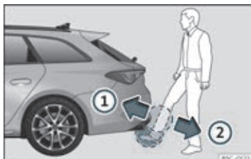
Fig. 88 Bagklap med sensorstyret åbning (Easy Open)
