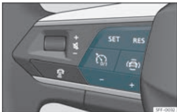
Fig. 165 På multifunktionsrattet: knapper til betjening af fartpilot
