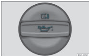
Fig. 216 Dækslet på påfyldningsåbningen til motorolie i motorrummet
