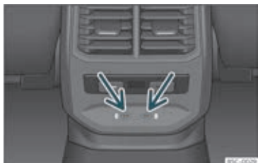
Fig. 152 Midterkonsol bag: USB-porte med stikdåsefunktion
