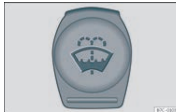
Fig. 220 I motorrummet: dæksel på sprinklervæskebeholder
