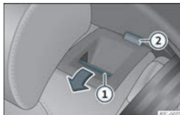
Fig. 111 Bagsæde: fremklapning af ryglæn
