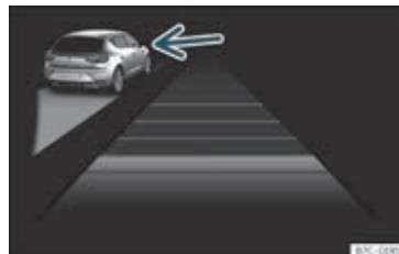
Fig. 172 På kombiinstrumentets skærm: ACC aktiv, køretøj registreret i venstre side
