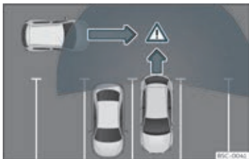
Fig. 183 Skematisk billede af udkørselsassistentens overvåget område for bil, der kører ud fra parkeringsbås
