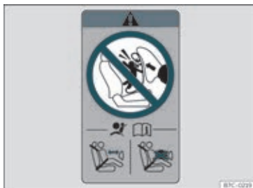
Fig. 30 Airbagmærkat: på passagerdørens bageste ramme
