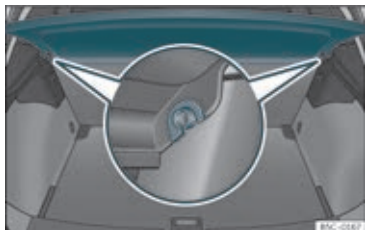
Fig. 115 I bagagerummet: af- og påmontering af bagagerumsafdækning
