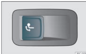
Fig. 198 I venstre side af bagagerummet: kontakt til frigørelse af anhængertræk
