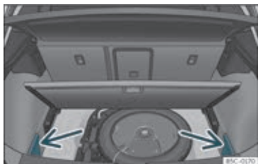
Fig. 116 I bagagerummet: afdækninger til opbevaring af bagagerumsafdækning
