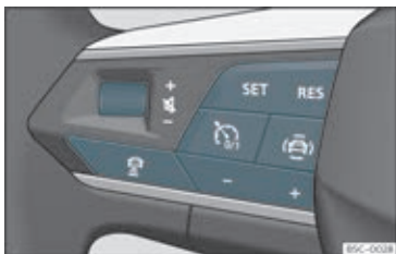
Fig. 170 På multifunktionsrattet: knapper til betjening af ACC
