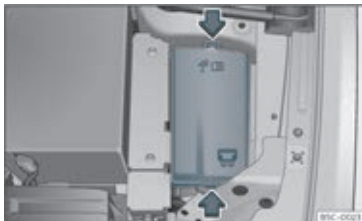
Fig. 52 I motorrummet: afdækning på sikringsboks
