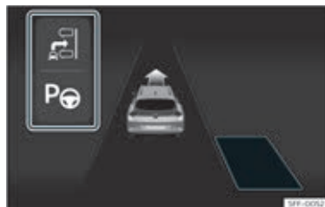
Fig. 189 På kombiinstrumentets skærm: visning af parkeringsstyreassistenten med begrænset visning.
