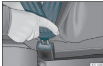
Fig. 13 Sådan sættes sikkerhedssele på i selelåsen.
