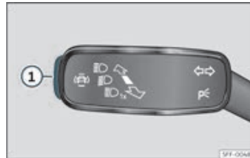
Fig. 65 På blink- og fjernlysarmen: knap til førerassistentsystemer (afhængigt af model)
