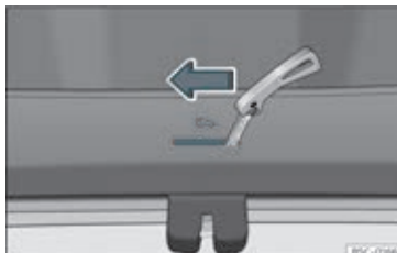
Fig. 89 Udsnit af bagagerummet: nødoplåsning (Leon)
