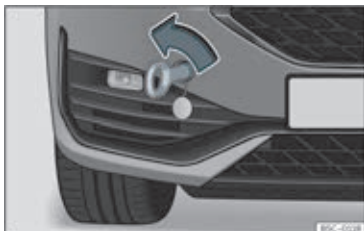
Fig. 48 Stødfanger foran i højre side: slæbeøje, der er skruet i
