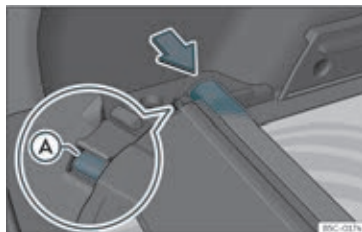
Fig. 121 I bagagerummet: holder til opbevaring af afdækning, der kan rulles ind
