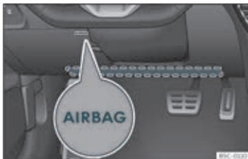
Fig. 21 I førersiden: knæairbaggens monteringssted
