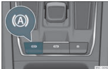
Fig. 187 I den nederste del af midterkonsollen: knap til Auto Hold-funktion
