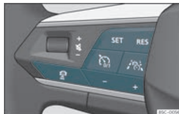
Fig. 178 På venstre side af multifunktionsrattet: knapper til betjening af Travel Assist
