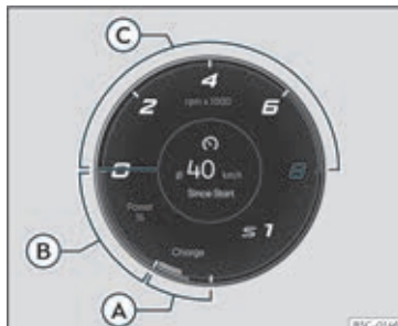
Fig. 60 Frit konfigurerbart kombiinstrument: powermeter (klassisk visning)
