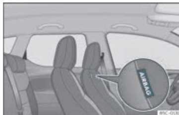
Fig. 23 På førersædets ryglænspolstring: centerairbag
