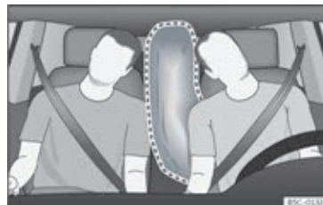
Fig. 24 Centerairbag, der er foldet helt ud (udløsningsområde)
