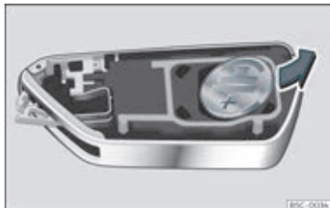
Fig. 77 Bilnøgle: udtagning af batteri
