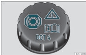
Fig. 219 I motorrummet: dæksel på bremsevæskebeholder
