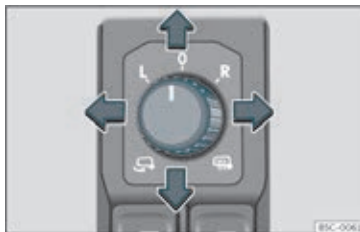
Fig. 102 Udsnit af førerdøren: drejknop til sidespejlene
