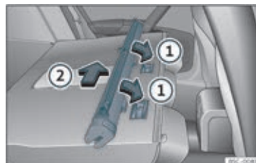
Fig. 133 Montering af netskillevæg på bagsæderyglæn
