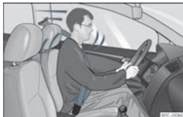
Fig. 10 Hvis sikkerhedsselen er spændt korrekt, bliver føreren ikke kastet frem ved en pludselig opbremsning.
