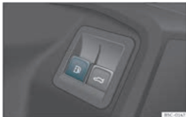
Fig. 209 Førerdør: åbning af tankklap
