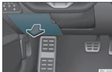
Fig. 51 Instrumentpanelet i førersiden: afdækning på sikringsboks
