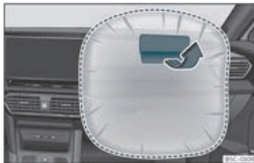
Fig. 18 Forsædepassagerens frontairbag i instrumentpanelet
