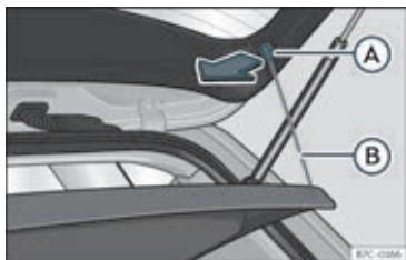
Fig. 114 I bagagerummet: af- og påmontering af bagagerumsafdækning
