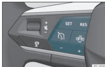
Fig. 166 På multifunktionsrattet: knapper til betjening af hastighedsbegrænser
