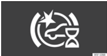
Fig. 168 På kombiinstrumentets skærm: visning af systemets første egenkalibrering
