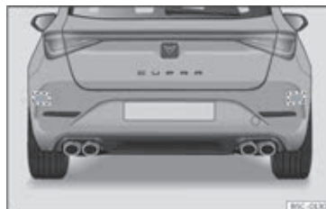
Fig. 162 Bilen set bagfra: radarsensorens område
