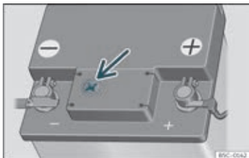
Fig. 221 Inspektionsrude på oversiden af bilens 12-volts-batteri (principskitse)
