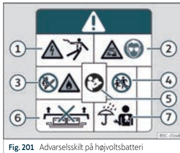
Fig. 201 Advarselsskilt på højvoltsbatteri
