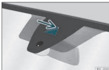
Fig. 161 På forruden: vognbaneassistentens kamerafelt
