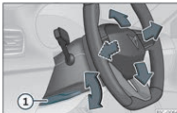
Fig. 8 Betjeningsarm nederst på rattstammen i venstre side
