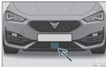
Fig. 159 | Forreste stødfanger: radarsensor
