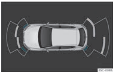
Fig. 195 Visning af parkeringshjælp på infotainmentsystemets skærm
