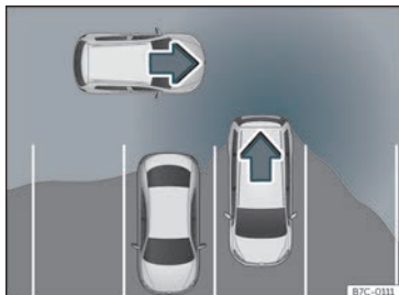
Fig. 224 Schematisk billede af udkørselsassistenten: overvåget område for bil, der kører ud fra parkeringsbåse
