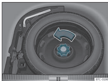
Fig. 254 Nødhjul: bundplade, der er klappet op
