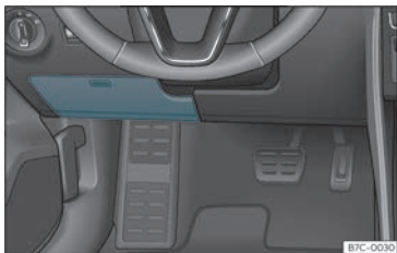
Fig. 88 Venstrestyret bil: afdækning på sikringsboks under instrumentpanelet i førersiden
