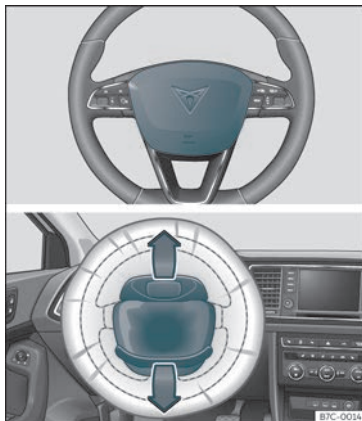
Fig. 20 Førerens frontairbag er placeret i rattet.
