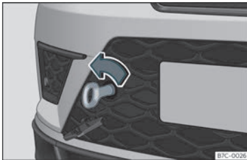
Fig. 64 Højre side af den forreste stødfanger: slæbeøj, der er skruet i
